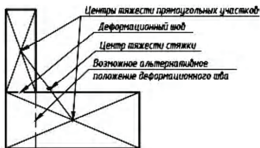
Рисунок 1 – Расположение деформационных швов для L-образных поверхностей стяжек, если центр тяжести находится за пределами поверхности.
