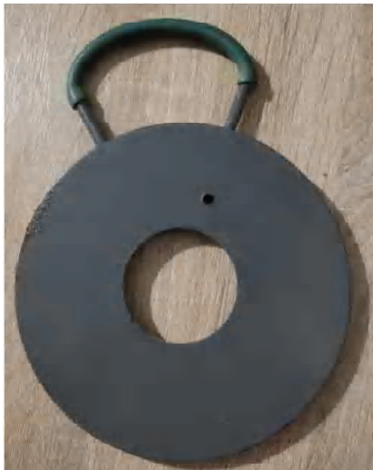
Рисунок 8 – Диафрагма стандартная для измерения расхода газа.
