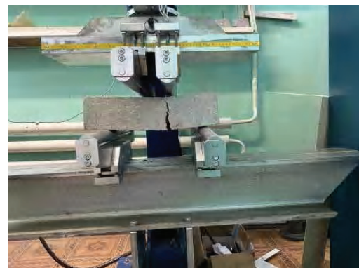
Рисунок 6 – Испытание на изгиб бетонной балки, армированной кокосовым волокном.
