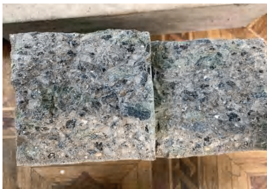
Рисунок 8 – Поперечное сечение изгибаемого образца балки из обычного бетона.
