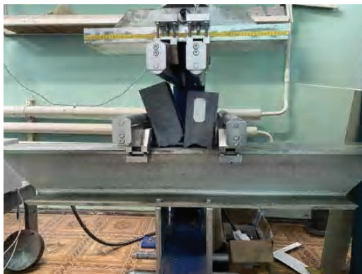
Рисунок 5 – Испытание на изгиб обычных железобетонных элементов балки.
