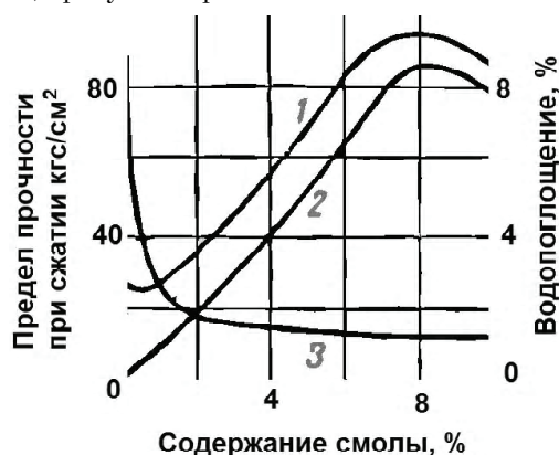
Рисунок 1 – Зависимость прочности образцов грунта от количества ФАС: 1 – воздушно-сухие образцы; 2 – водонасыщенные; 3 – суточное водопоглощение.
