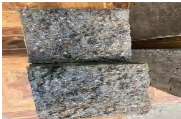
Рисунок 9 – Поперечное сечение изгибаемого образца балки из бетона, армированного коксовым волокном.
