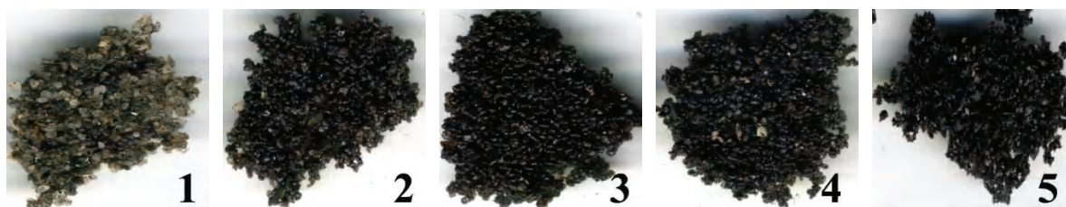
Рисунок – Влияние добавки ДАД-ТА на сцепление битума БНД70/100 с песком.
