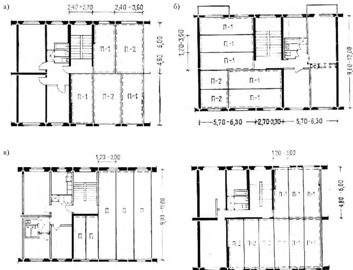
Рисунок 1 – Схемы планов панельных бескаркасных зданий с поперечными несущими стенами: а) с малыми пролетами между несущими стенами; б) с большими пролетами между несущими стенами; в) со смешанными пролетами (большими и малыми).
