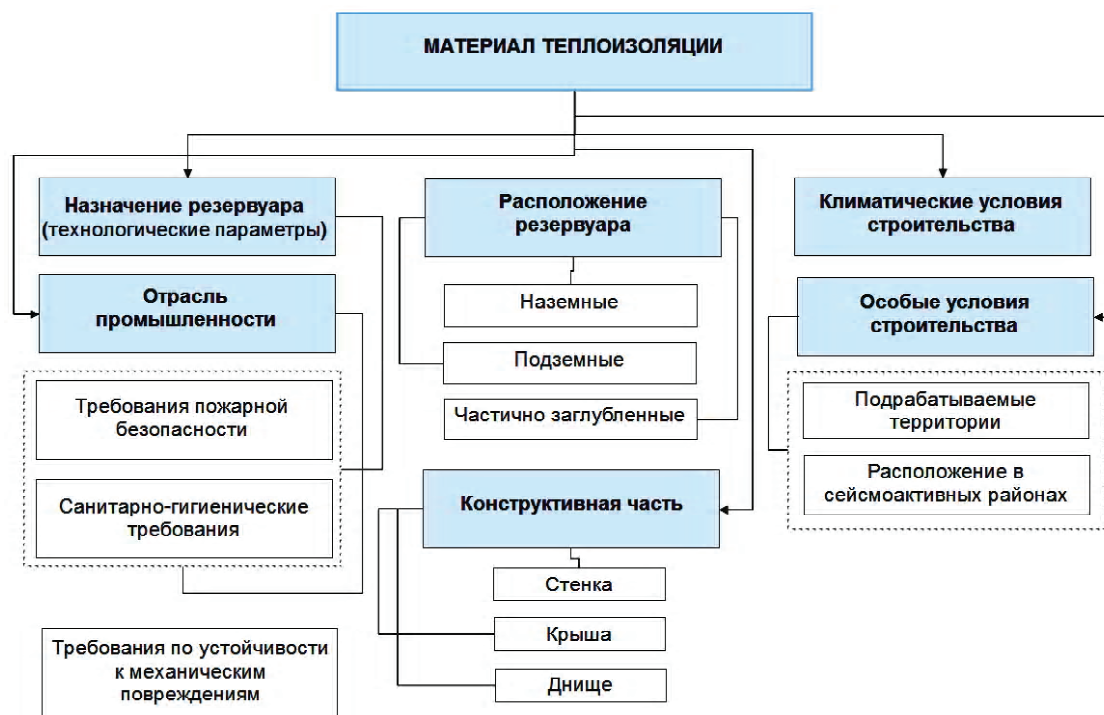
Рисунок 2 – Основные факторы, влияющие на выбор теплоизоляционного материала с учетом его физико-технических характеристик.
