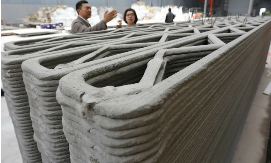
Рисунок 1 – Решетка треугольного типа, компания «WinSun», Китай.
