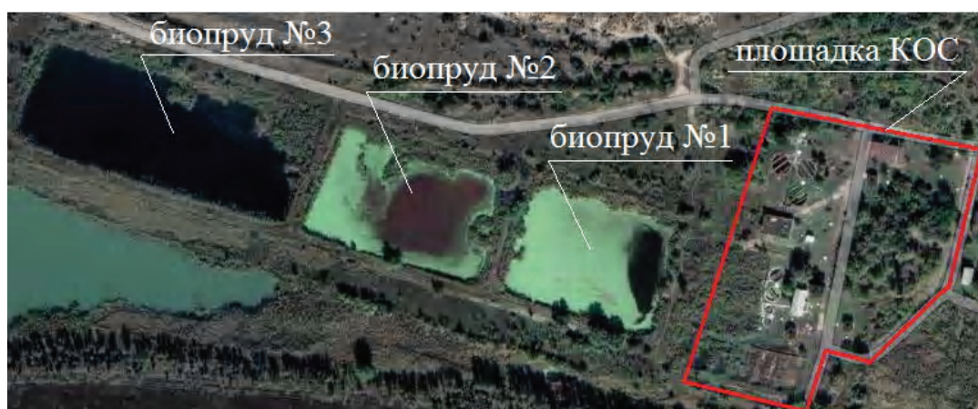
Рисунок 2 – Спутниковый фотоснимок площадки КОС пгт. Гольмовский с биопрудами.
