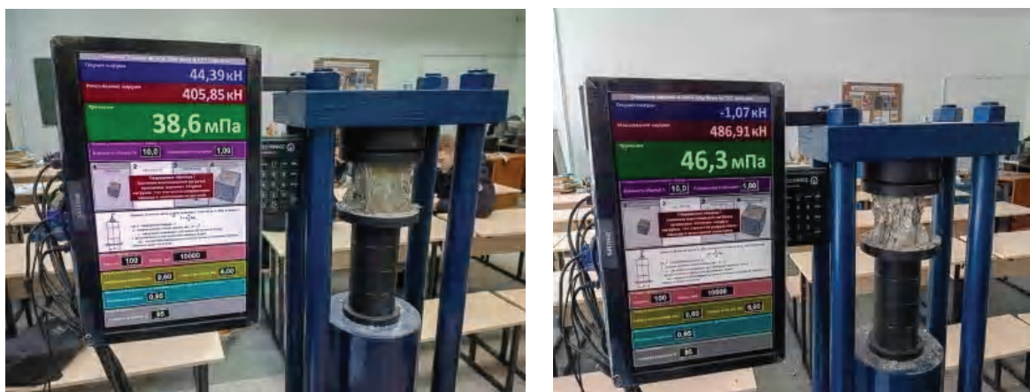
Рисунок 2 – Проведение прочностных испытаний при сжатии тяжелого цементного бетона в стандартном возрасте 28 сут.
