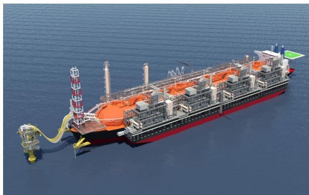
Конверсия танкера по перевозке сжиженного природного газа (СПГ) Moss – Golar-Keppel
