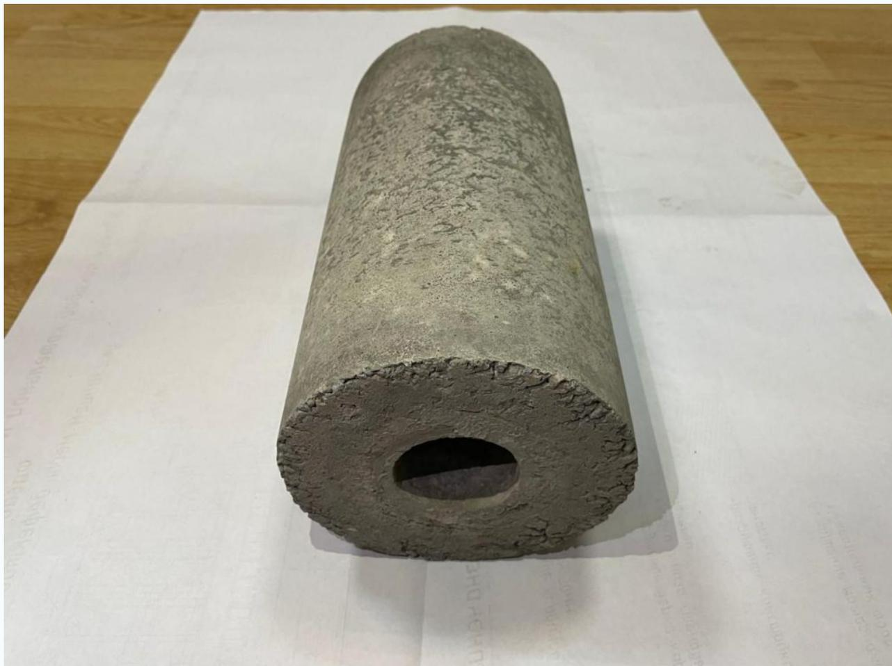
Как результат, исследователями создан вариатропный бетон с улучшенными характеристиками: устойчивый к низким температурам и высокопрочный. Создатели отмечают, что прочность этого бетона выше на 79%, а устойчивость к воздействию холода – на 27%.
