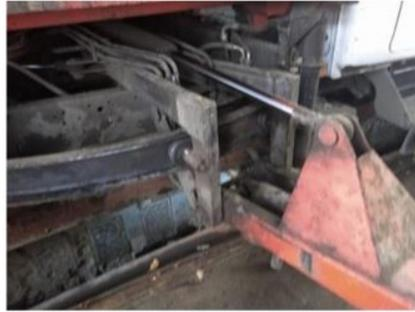
Рис. 2 - Секторное поворотное устройство
