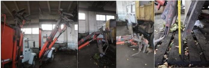
Рис. 4 - Кинограмма угла наклона стрелы
