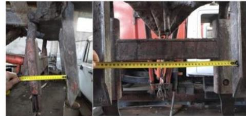
Рис. 5 - Параметры захвата
