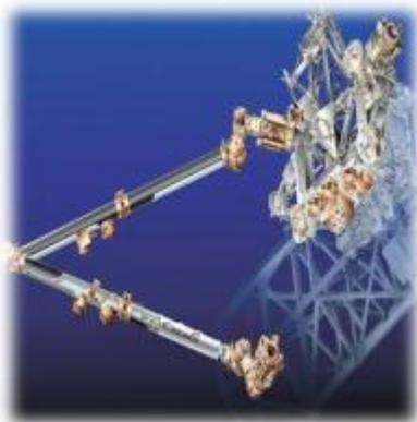
Определение оптимальной по расходу ресурсов траектории движения манипулятора Эра в космическом пространстве.
