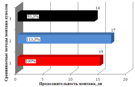
ГИСТОГРАММА ПРОДОЛЖИТЕЛЬНОСТИ РАБОТ ПРИ МОНТАЖЕ ЖЕЛЕЗОБЕТОННОГО КУПОЛА-ОБОЛОЧКИ
