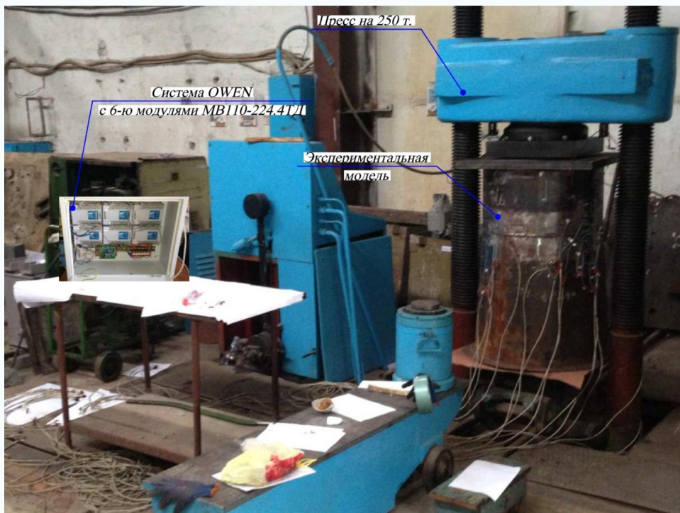
Экспериментальная установка для исследования цилиндрических и конических оболочек
