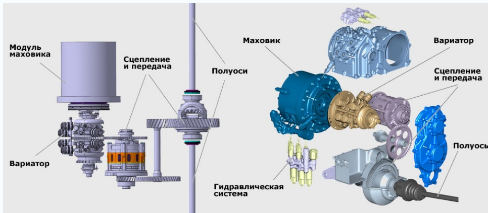
Одна из схем механической система рекуперации энергии автомобиля
