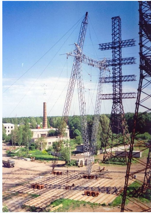
Испытания V-образной опоры на оттяжках для Исландии
