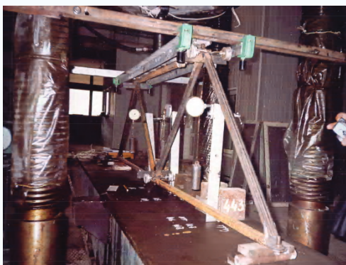
Испытание блока структурной конструкции в гидравлическом прессе (P=1000 т)
