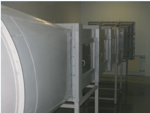
Внешний вид и рабочая часть метеорологической аэродинамической трубы МАТ-1 ДонНАСА
