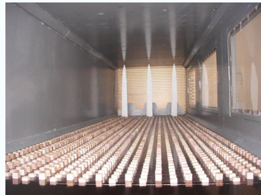
Внешний вид и рабочая часть метеорологической аэродинамической трубы МАТ-1 ДонНАСА
