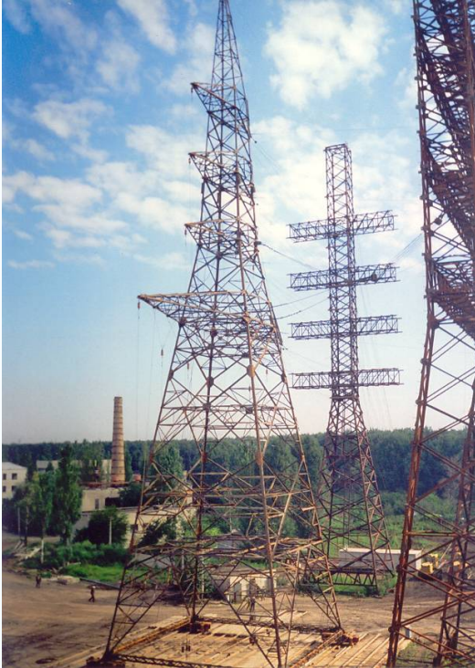
Испытания опоры высотой 62 м и весом 54 т для Египта
