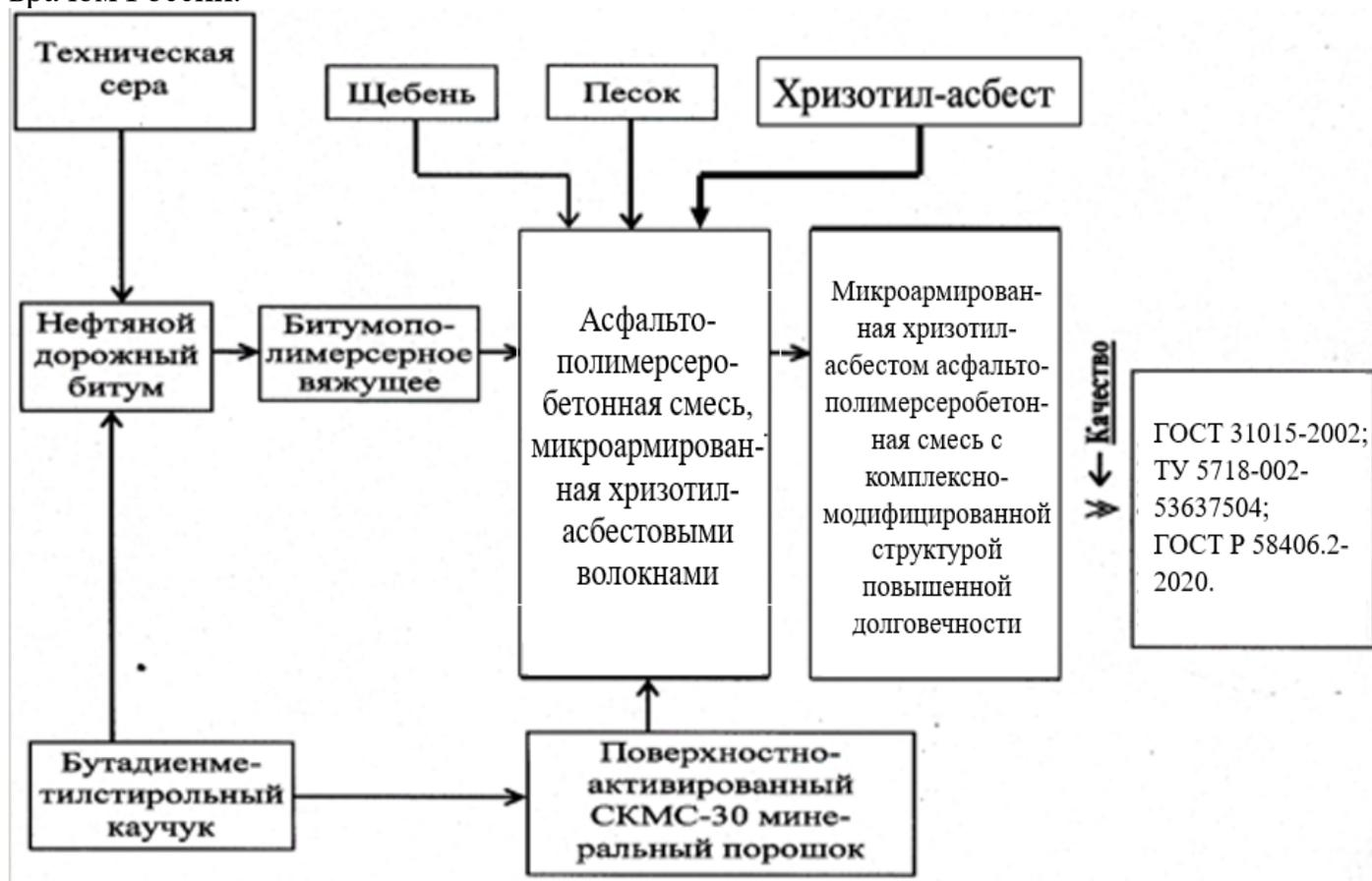
**Рисунок 1** – Блок-схема получения горячей асфальтополимерсеробетонной смеси с комплексно-модифицированной микроструктурой, дисперсноармированной хризотил-асбестовыми волокнами.
