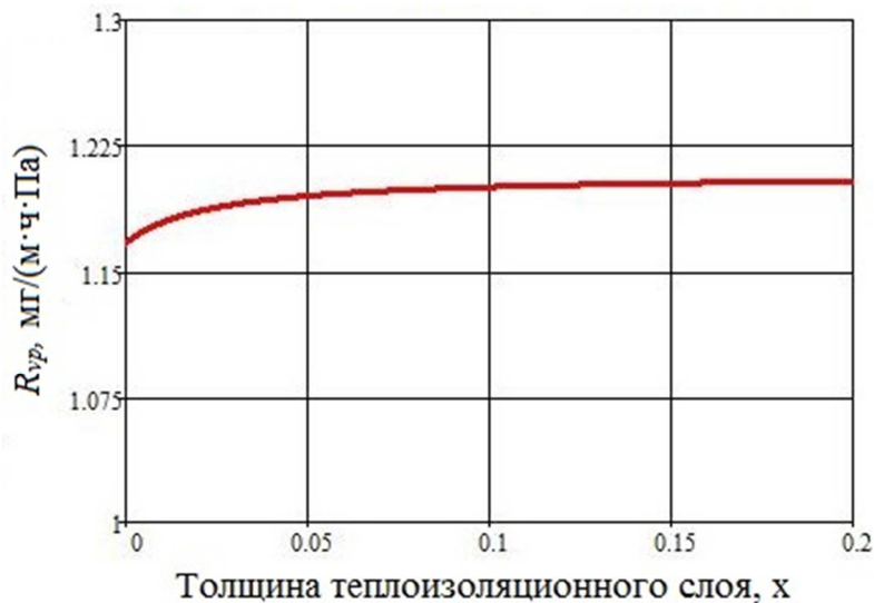
Рисунок 1 - График зависимости R_{vp}^{req} от толщины теплоизоляционного слоя \delta_m .
