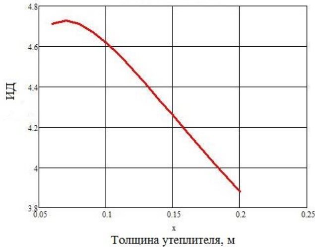
Рисунок 4.2 - Зависимость ИД от толщины теплоизоляционного слоя
