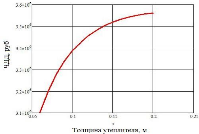
Рисунок 4.1 - Зависимость ЧДД от толщины теплоизоляционного слоя
