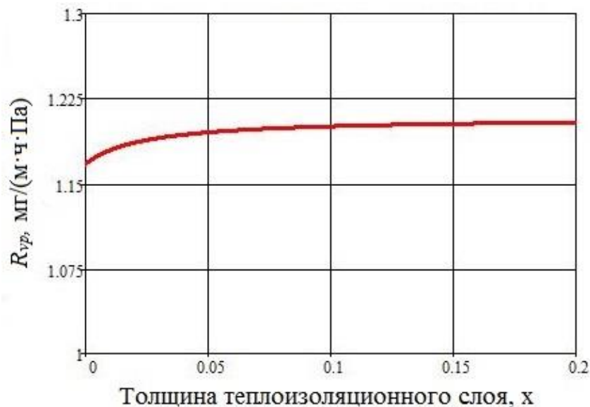
Рисунок 2.3 - График зависимости функции сопротивления паропроницаемости от толщины теплоизоляционного слоя \delta_m
