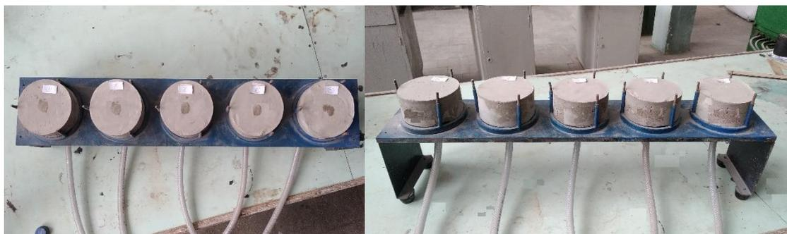
Рис. 4.10 Установка для определения водонепроницаемости образцов бетона
