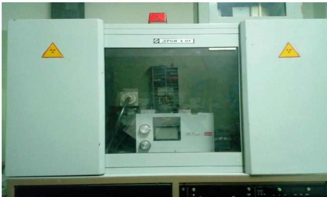
Рис. 2.4. Дифрактометр рентгеновский общего назначения "ДРОН 4-07"
