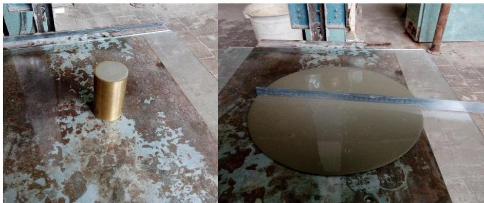
Рис. 2.1. Определение диаметра расплыва цементного теста
