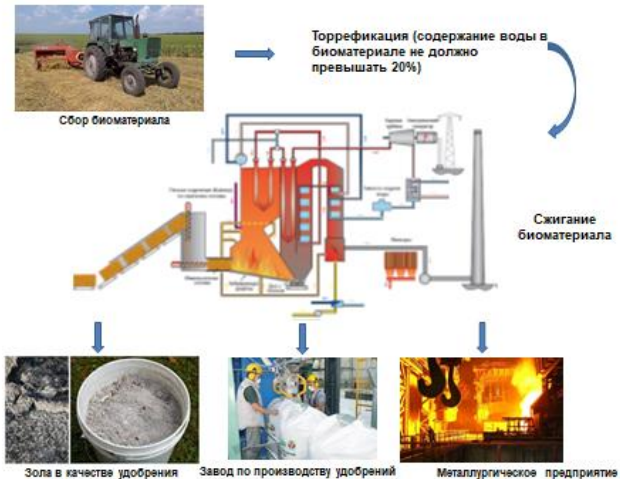
Рисунок 12 – Технологическая схема фиторемедиации почв, загрязненных тяжелыми металлами с получением биотоплива
