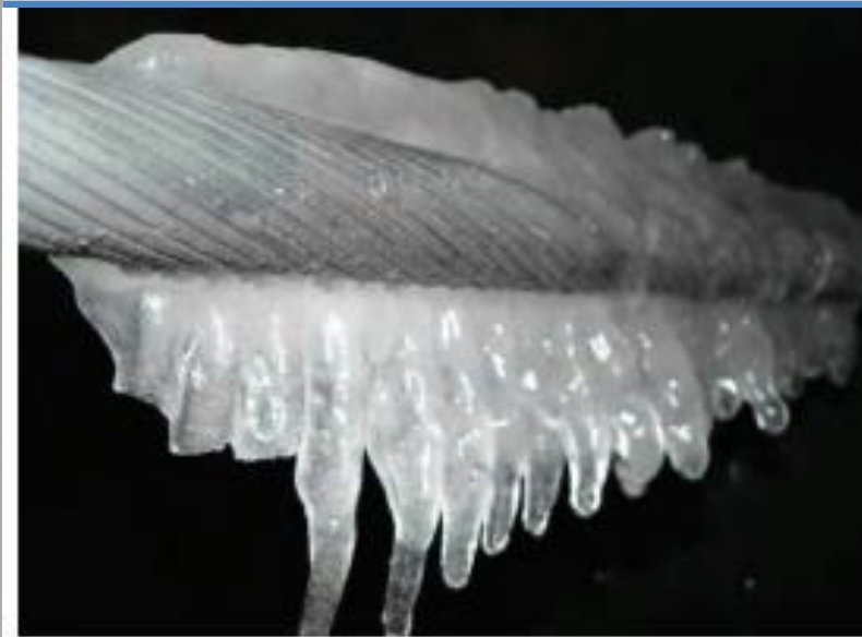
Исследование в климатической камере процесса намораживания гололеда на провода линий электропередачи
