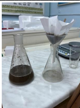
Рисунок 4 - Приготовление водной вытяжки
