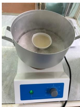
Рисунок 5 - Выпаривание водной вытяжки на водяной бане
