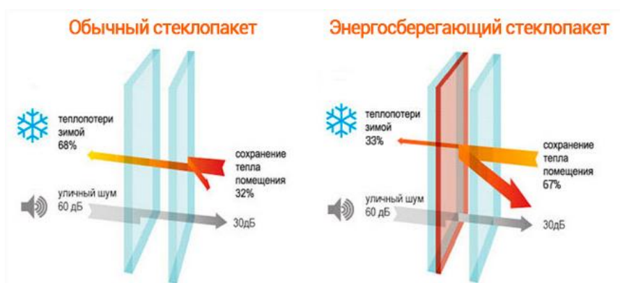
Рисунок 1 - Работа обычного и энергосберегающего стеклопакета
