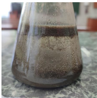
Рисунок 1 – Процесс флотации биологического осадка по истечению 45 секунд
