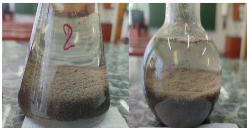
Рисунок 2 – Пробы биологического осадка после добавления сульфата двухвалентного железа и пероксида водорода
