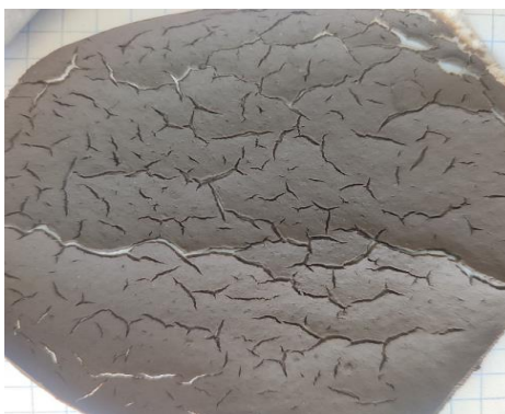
Рисунок 4 – Осадок после обезвоживания влажностью 72%
