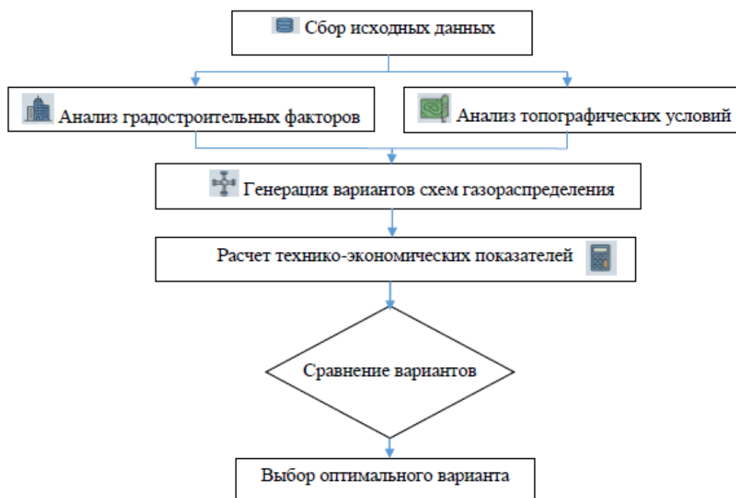
Рисунок 3 – Блок-схема методики выбора оптимальной схемы газоснабжения с учетом градостроительных и топографических факторов
