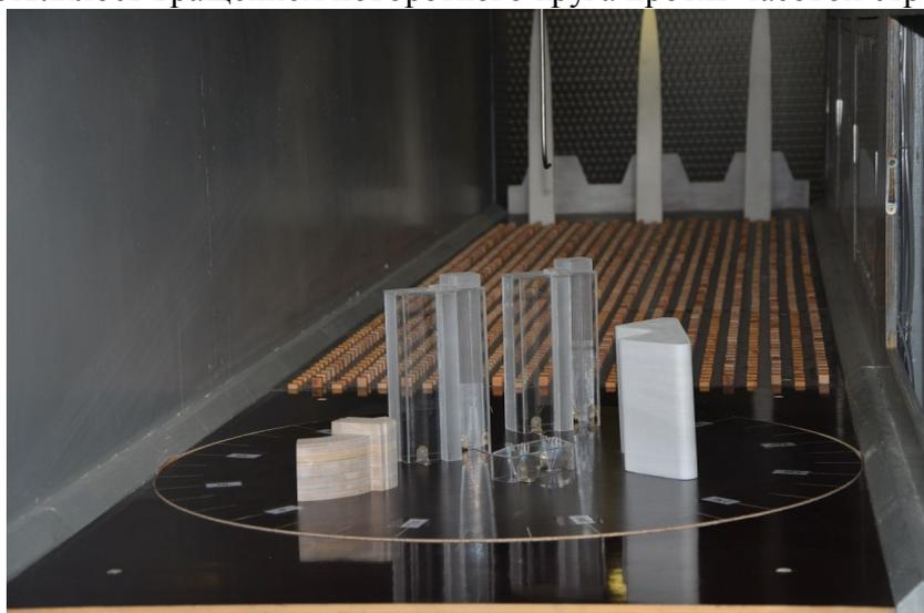
Рис. 3. Внешний вид рабочей части трубы с поворотным кругом.
