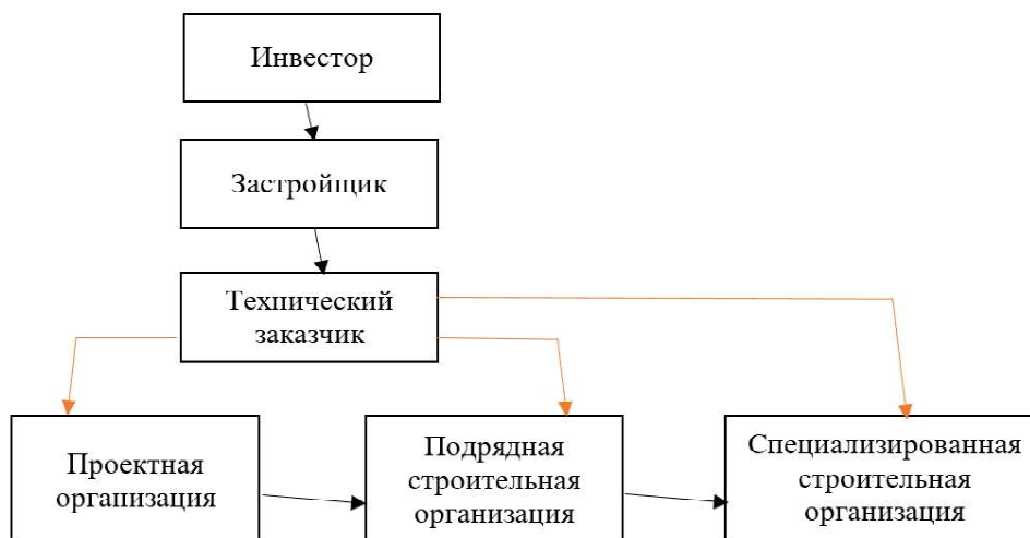
Рисунок – Схема взаимодействия участников инвестиционно-строительного процесса.
