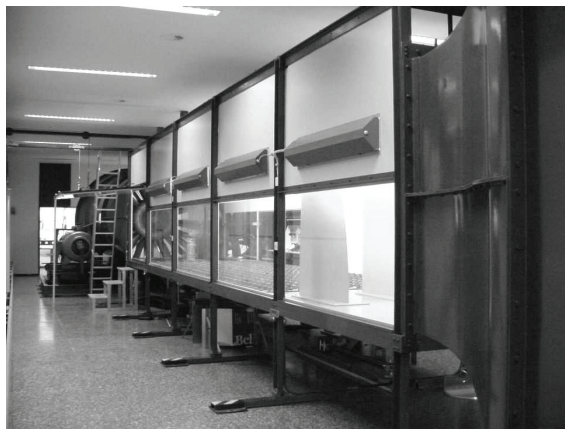
Рисунок 4. Аэродинамическая труба Рурского университета г. Бохум (Германия).
