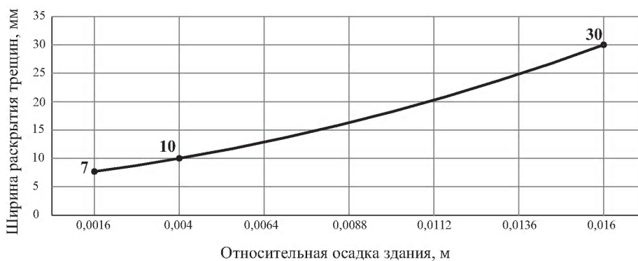
Рисунок 10. Зависимость величины раскрытия трещин от относительной осадки здания.
