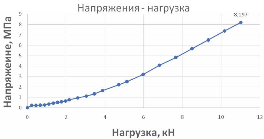
Рисунок 9. Значение напряжений по бетону в центре пролета от датчиков № 4, 5, 6.
