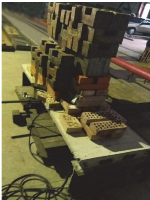
Рисунок 6. 23-е нагружение на сталежелезобетонную плиту.
