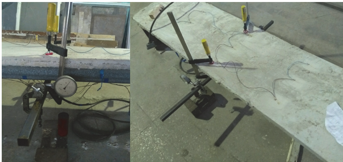
Рисунок 4. Установка и вид прогибомера ПАО-6.
