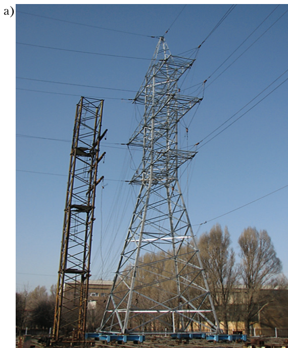
Рисунок 5. Оптимальная двухцепная анкерно-угловая опора У110-2+14: а) в процессе стендовых испытаний У110-2+9; б) общий вид смонтированной опоры на линии.
