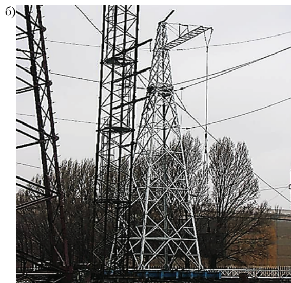
Рисунок 12. Промежуточная опора ПБ43т (а) и анкерная-угловая опора У21к (б) на силовом полу (Казахстана).
