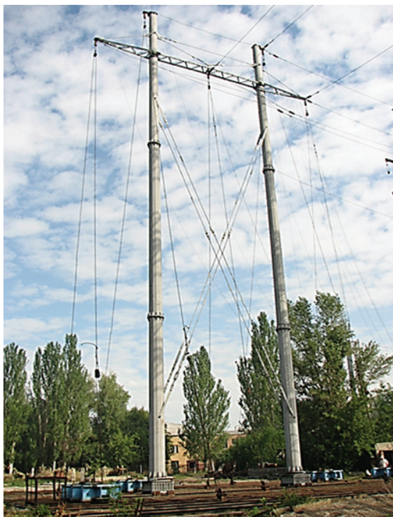
Рисунок 6. Одноцепная промежуточная опора portalного типа ПМГ 330-28 на базе МГС в процессе стендовых испытаний.
