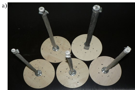
Рисунок 14. Образцы, подготовленные для аэродинамических испытаний: а) образцы проводов; б) образец, установленный на тензовесах аэродинамической трубы.
