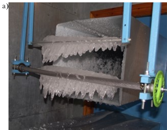
Рисунок 13. Образование гололеда: а) на контрольном и исследуемом образце провода; б) поперечный разрез гололедного образования на исследуемом образце провода.
