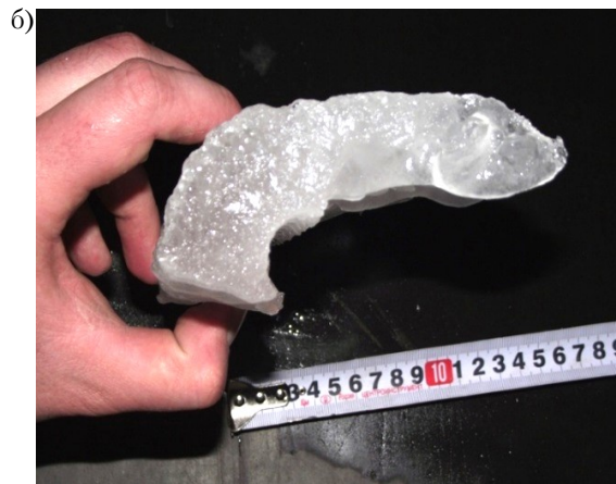
Рисунок 13. Образование гололеда: а) на контрольном и исследуемом образце провода; б) поперечный разрез гололедного образования на исследуемом образце провода.
