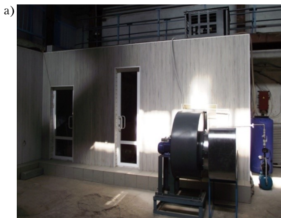
Рисунок 12. Климатическая камера ФГБОУ ВО «ДОННАСА»: а) общий вид; б) вентилятор, нагнетательный и обратный воздушные каналы с наружной теплоизоляцией.
