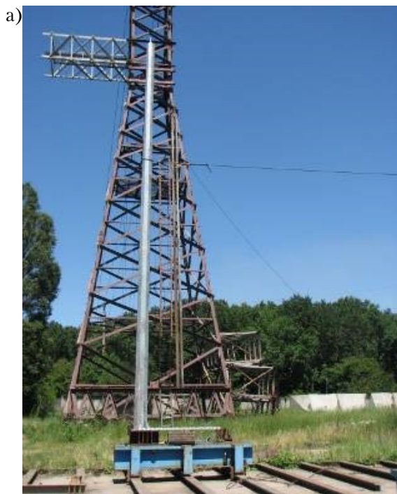
Рисунок 2. Контрольные испытания стойки МГС «Авдеевский завод металлоконструкций»: а) стойка на силовом полу; б) стойка в процессе испытаний.
