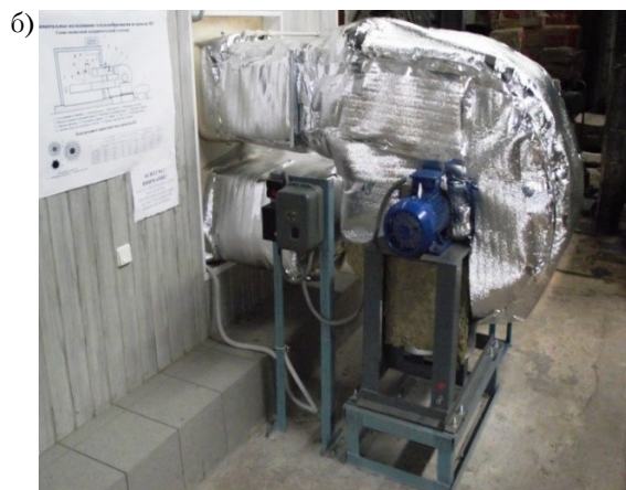
Рисунок 12. Климатическая камера ФГБОУ ВО «ДОННАСА»: а) общий вид; б) вентилятор, нагнетательный и обратный воздушные каналы с наружной теплоизоляцией.
