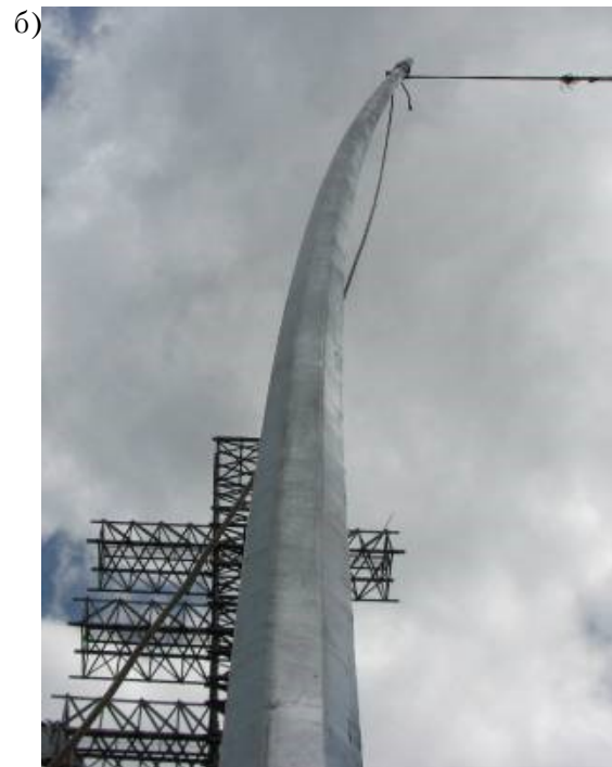
Рисунок 2. Контрольные испытания стойки МГС «Авдеевский завод металлоконструкций»: а) стойка на силовом полу; б) стойка в процессе испытаний.
