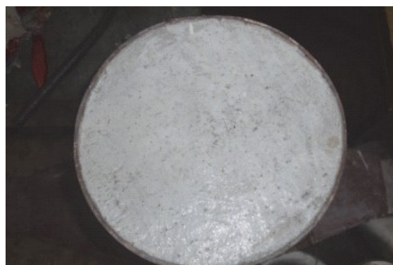
Рисунок 3. Фото экспериментальных рамных ТБ узлов с бетоном внутри труб.
