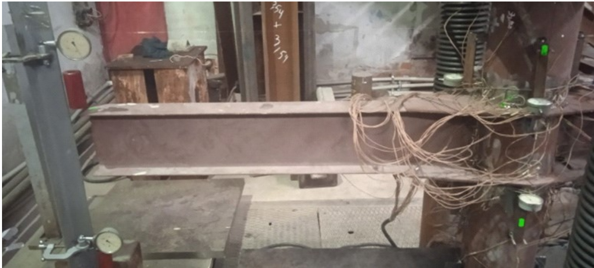
Рисунок 7. Схема расположения прогибометров, для измерения углов поворота.
