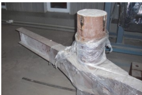
Рисунок 3. Фото экспериментальных рамных ТБ узлов с бетоном внутри труб.
