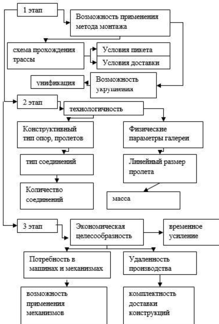
**Рисунок 1.** Этапы разработки структуры монтажно-технологического процесса возведения транспортной галереи в условиях действующего предприятия.
