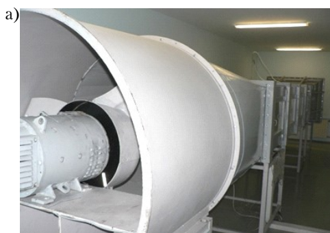
Рисунок 12. Проведение исследований аэродинамических характеристик проводов в аэродинамической трубе МАТ-1: а) общий вид аэродинамической трубы МАТ-1; б) расположение образца провода в рабочей части МАТ-1.
