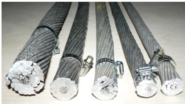
Рисунок 1. Образцы проводов марки АС для экспериментальных исследований: АС 150/24, АС 185/24, АС 240/32, АС 300/39, АС 450/56.
