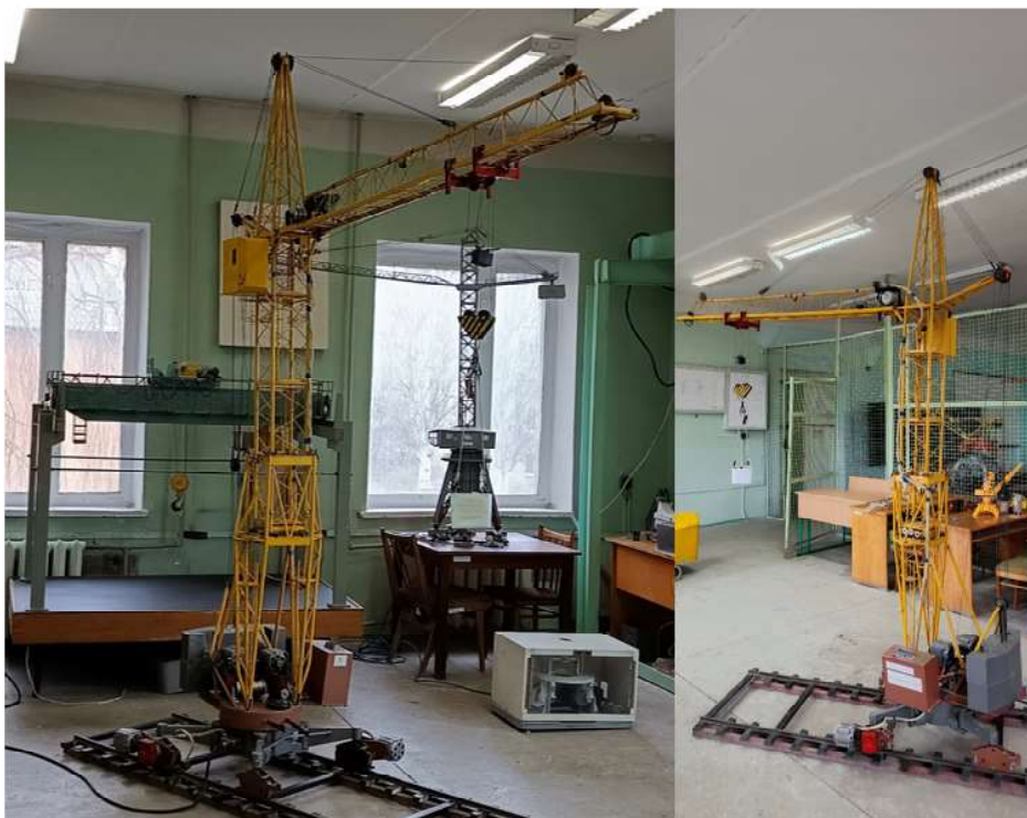
Рисунок 3. Лабораторная модель башенного крана, использованная для исследования динамических характеристик металлоконструкции.
