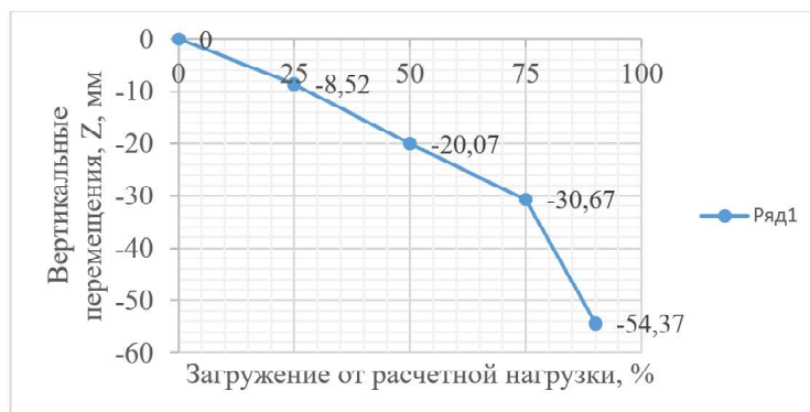
Рисунок 11. Нормальный режим/Ветер с гололедом (1-я схема нагружения). Зависимость вертикальных перемещений на правом конце траверсы от уровня прикладываемой к опоре нагрузки.
