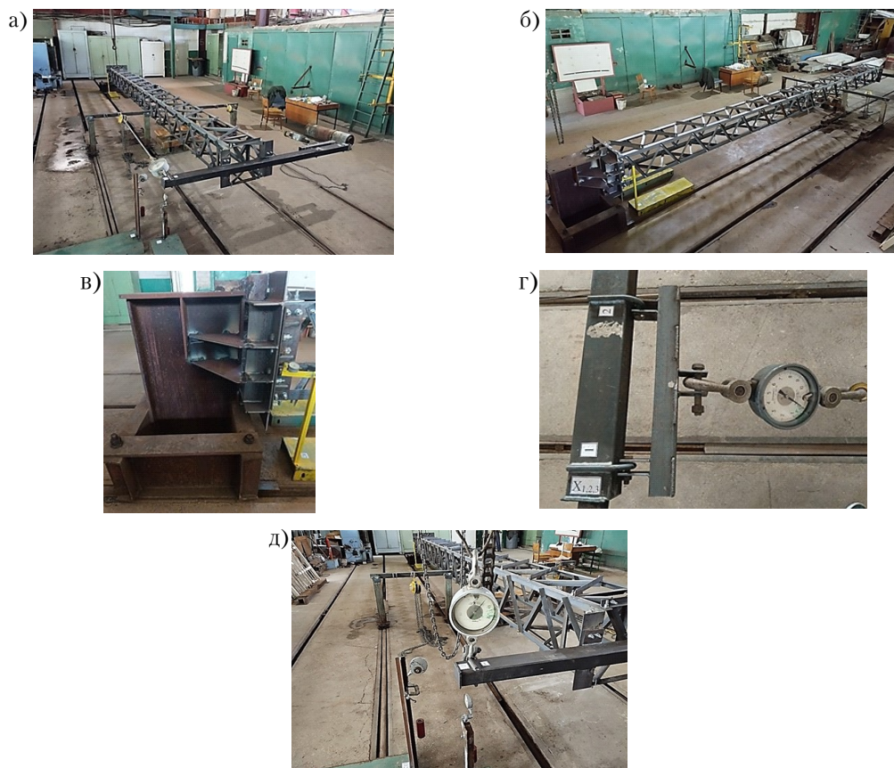
Рисунок 10. Общий вид экспериментальной установки при испытаниях опоры типа П10ГИ-4М: а, б) общий вид испытуемой опоры с силовыми рамами, установленными на силовом полу с ручьями; в) конструкция опорной тумбы (поз. 3) для жесткого закрепления базы опоры; г) распределительная траверса с закрепленным на ней динамометром ДПУ-10-2, передающая нагрузку на опорные скобы крепления 2-х фазных проводов; д) испытания опоры при аварийном режиме (Схема III) – загрузка правого конца траверсы вертикальным тяговым усилием T (рисунок 9, вид Г-Г) от механической тали г/п Q = 5 т.
