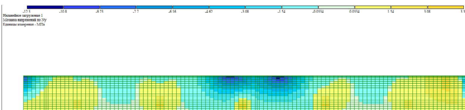
Рисунок 38 – Изополя распределения локальных напряжений \sigma_{loc} в стенке.
