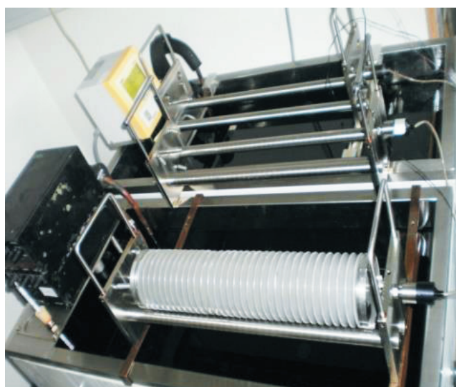
Рис. 3. Автоматизированный дилатометр для измерения аутогенной усадки бетонов
