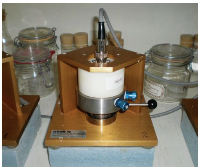
Рис. 2. Станция Rotronic Hygrosopic DT для измерения внутренней влажности бетонов
