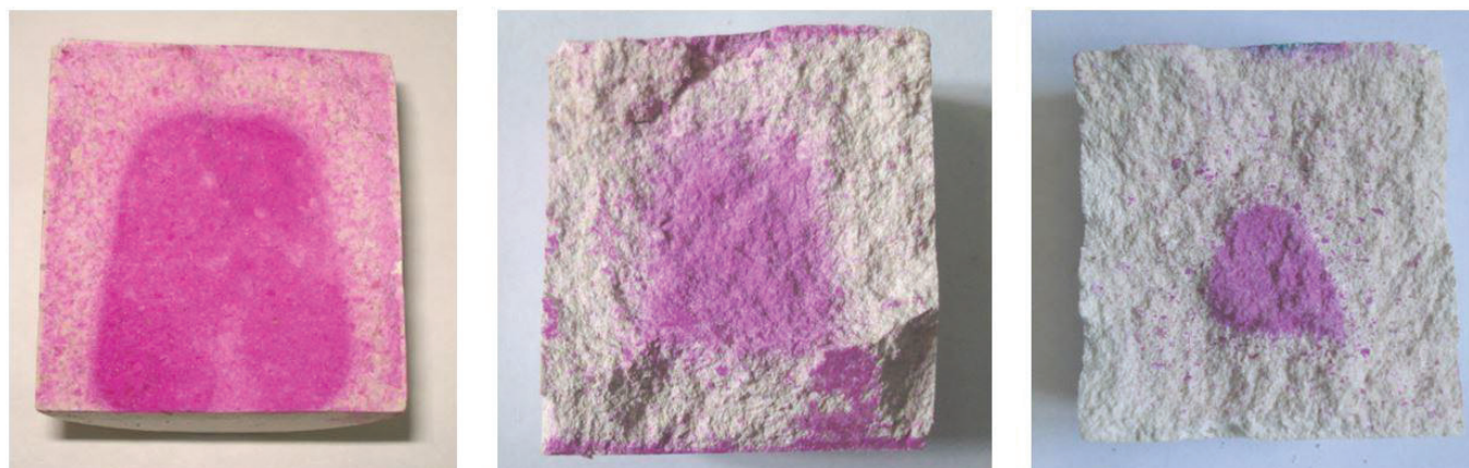
Рис. 5. Толщина карбонизированного слоя известковых образцов в зависимости от времени карбонизации, с: а – 3600; б – 4500; в – 5300
