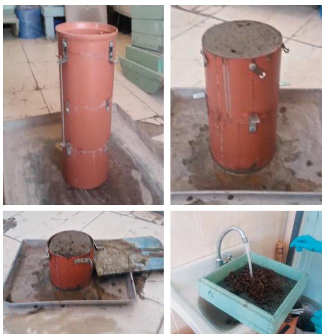
Рис. 4. Определение стойкости СУБ к сегрегации в трёхсекционной цилиндрической форме
