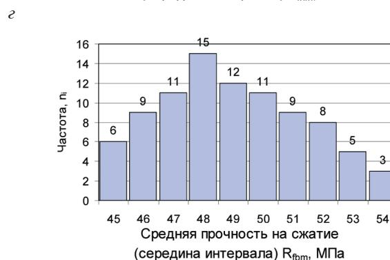
Рис. 1. Гистограммы распределения экспериментальных данных прочности на сжатие для образцов – кубов с разными типами фибр: а) токарной; б) проволочной в) листовой; г) фрезерованной; процент фибрового армирования  $\mu_{fv} = 2\%$
