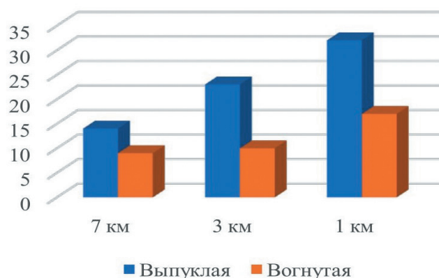
Рис. 17. Процент поражения стены трещинами в зависимости от радиуса мульды
