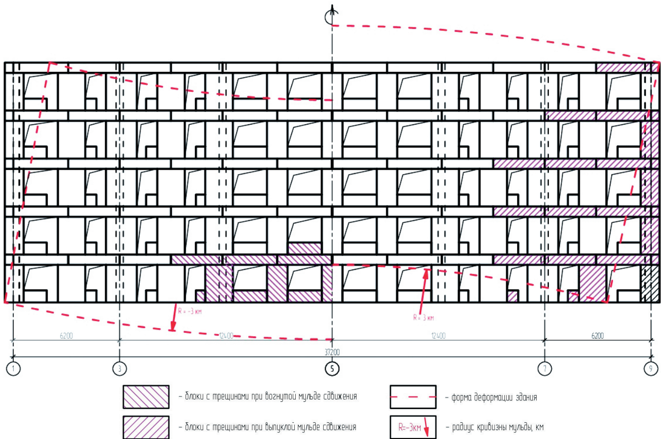
Рис. 12. Блоки стены по оси А с трещинами при радиусе кривизны мурды 3 км (мурда вогнутая – слева от центральной оси здания, мурда выпуклая – справа)
