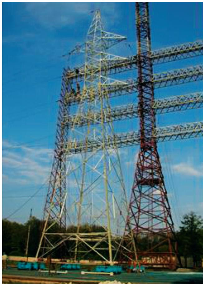
*На фото: испытание на Полигоне уникальной опоры ЛЭП для Египта высотой 64 м*
