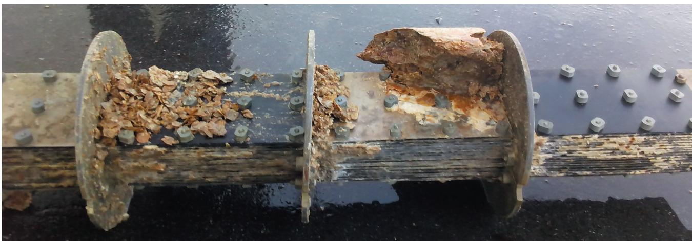
*Рис. 2. Пакет электродов спустя 5 месяцев эксплуатации на неподготовленной воде и при отсутствии автоматической регулярной кислотной промывки*
