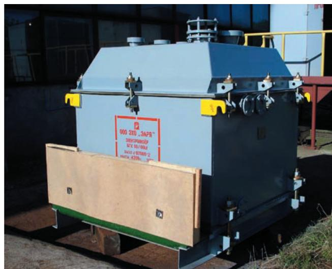
*Рис. 4. Промышленный диафрагменный электролизер типа БГК для генерации хлора и каустической соды производства ООО ЗХ «Заря» (Группа компаний «Спецмаш»)*
