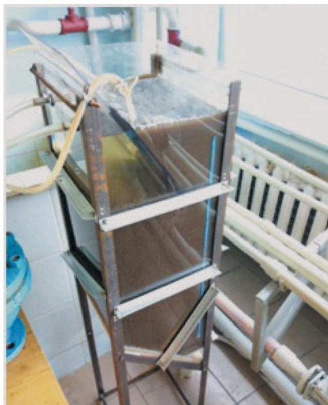
Рис. 3. Экспериментальная модель аэротенка-осветлителя с затопленной эрлифтной системой аэрации
