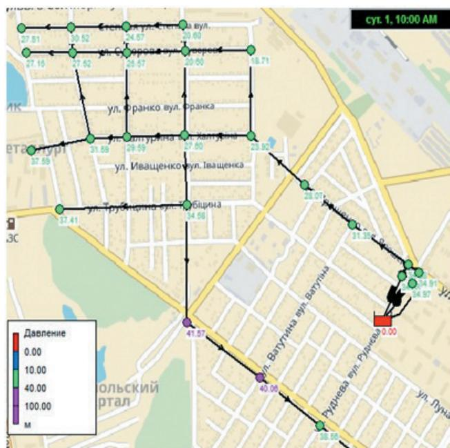
Рис. 1. Элемент расчетной модели СПРВ в среде Epanet
