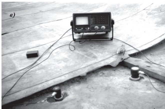
Рис. 3. К обследованию объектов Олимпиады-80: а – уточнение снеговых нагрузок на покрытия, б – комплексная оценка взаимодействия кровли и поверхности мембраны; в – уточнение прочностных характеристик материала несущих конструкций; г – оценка уровня напряжений неразрушающим методом
