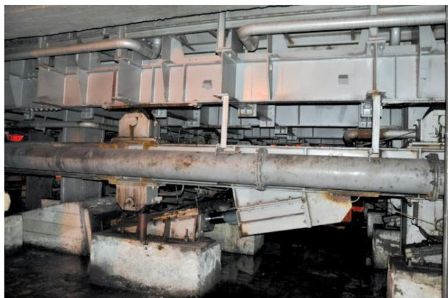
Рис. 16. Рама шагающего пода нагревательной печи стана 390
