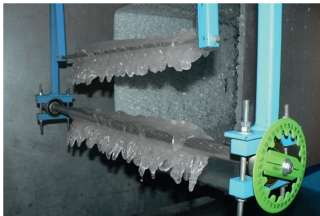
Рис. 12. Испытания проводов ВЛ в климатической камере лаборатории испытаний строительных конструкций и сооружений
