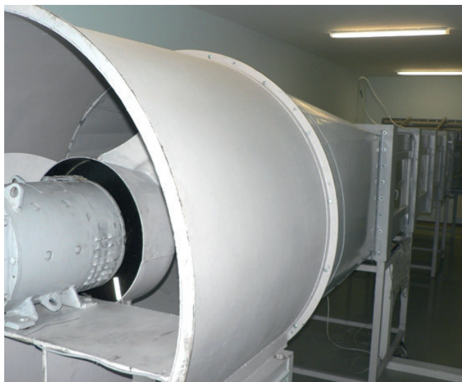
Рис. 13. Малая аэродинамическая труба МАТ-1 ДОННАСА
