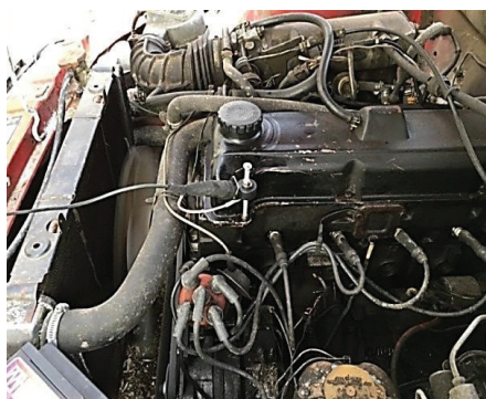
Рис. 8. Вид датчика 18.3855, закрепленного на головке блока цилиндров ДВС GM20E (а) и осциллограммы вибрационного сигнала на частоте вращения коленчатого вала 3000 об/мин.: 2 В/дел.; 2 мс/дел (б) и 4000 об/мин.: 5 В/дел.; 2 мс/дел (в)
