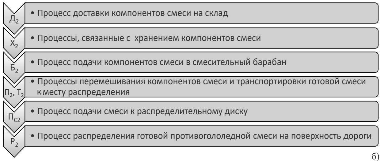
Рис. 4. Блок-схемы сопоставляемых технологий приготовления и распределения ПГМ: а – традиционная технология, б – новая технология
