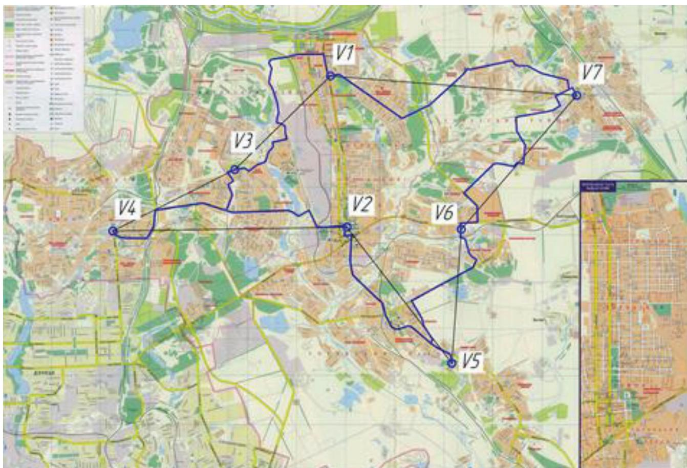
Рис. 5. Рациональные точки расположения и маршрут движения мобильной установки сортировки ТБО
